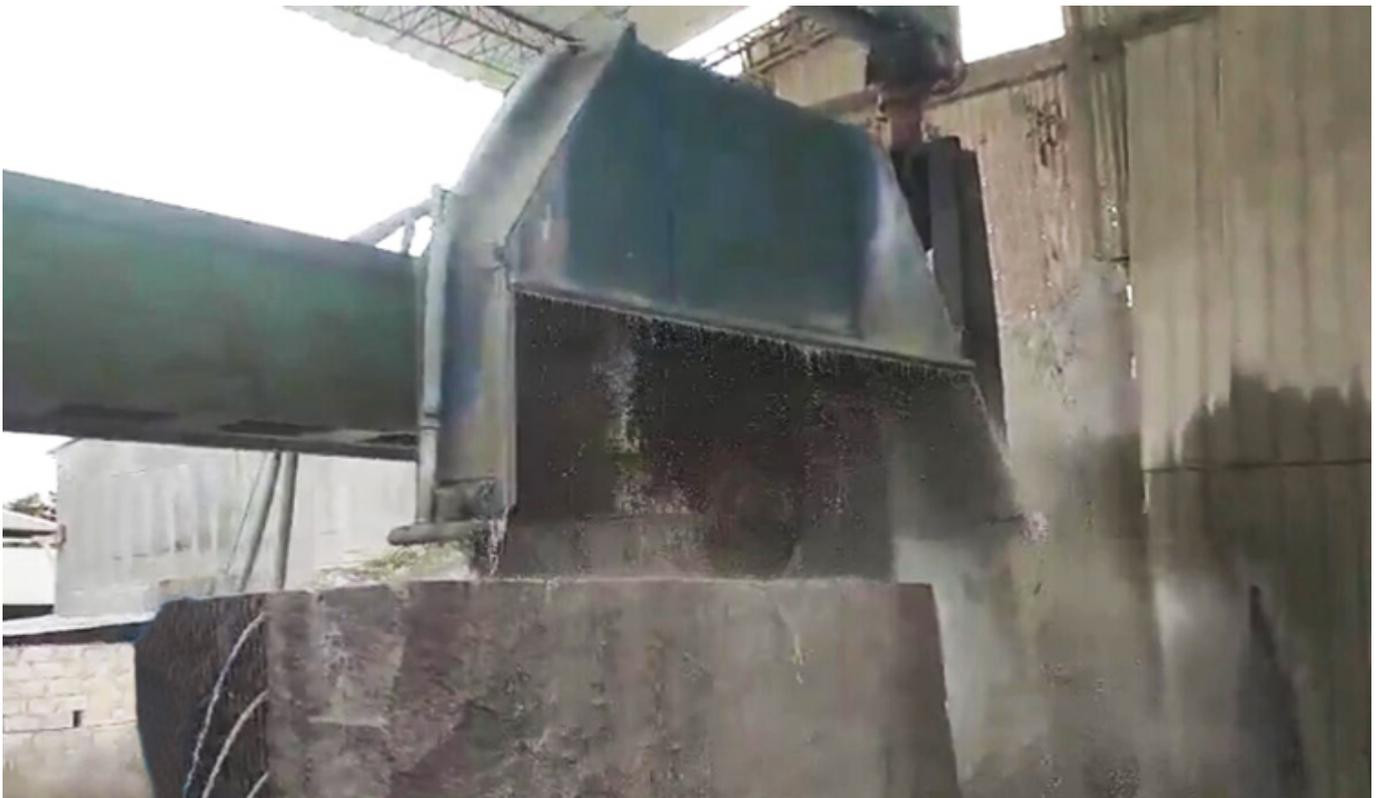
1. Wenn das Material hart ist, sollte die Bindung der Diamantsegmente weicher sein.
