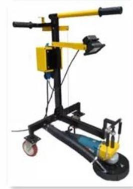
**Werkseitige Polar Magnetic Chuck Metallpads** kann für alle Arten von Beton- und Terrazzoböden, für die Schleifvorbereitung auf dem Boden oder für die Renovierung alter Fußböden verwendet werden.
