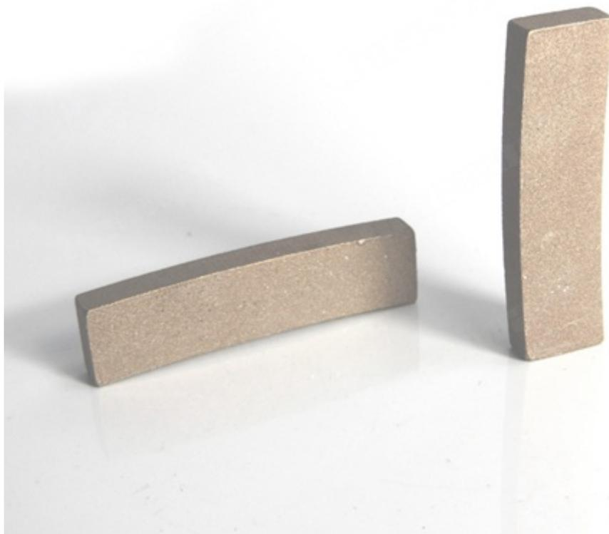
Notre **Segment de bord de diamant pour le granit** sont fabriqués à partir d'un mélange de poudre de diamant et de poudre métallique de haute qualité, produit par pressage et frittage, la poudre de diamant et la poudre métallique se combinent étroitement, la qualité est plus élevée et l'effet est meilleur.
