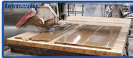
Le caratteristiche di **taglio diamantato a segmenti diamantati mediante taglio a blocchi** dovrebbe corrispondere alla natura del materiale da tagliare.
