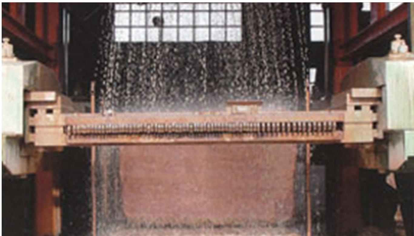
**Segmento de serra de gangue de diamantes para fornecedores.** Diamond O segmento de serra de gangue de corte suave é usado para cortar pedra nas minas, cortando os blocos suavemente em grandes lajes de pedra da mesma espessura, o que é conveniente para processamento e transporte posteriores.
