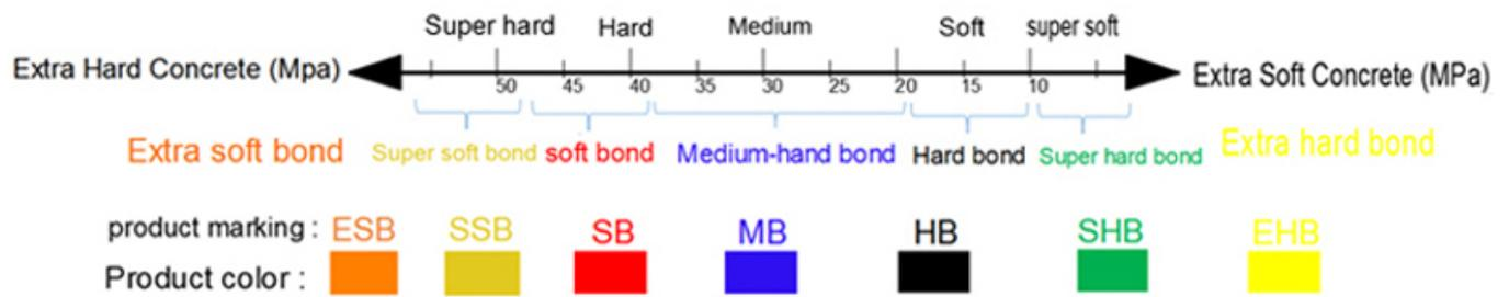
Soft Bond - O pó metálico no segmento sinterizado se desgasta rapidamente, liberando cristais de diamante opaco, expondo novos cristais abrasivos para corte eficiente. Melhor usado em superfícies duras.
